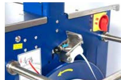
Détection automatique de feuilard, alimentation, détection de défaut et réglage de tension automatique
