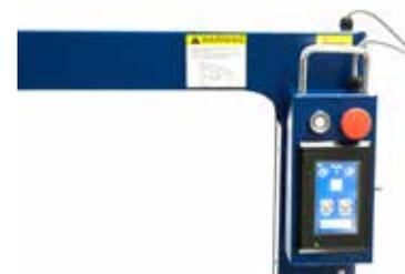
Ecran couleur tactile rotatif jusqu'à 180° pour faciliter l'usage de la machine
