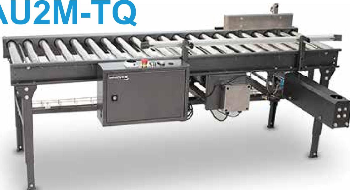
Convoyeur à rouleaux entraînés par une chaîne motorisée, roule avec une vitesse constante; doté d'une taqueuse reliée à un vérin pneumatique, et un automate de marque SIEMENS qui règle les fonctions de la machine. ce convoyeur est utilisé pour toutes sortes de marchandises comme des cartons, contenaires, bacs ou autres, il est construit pour être relié à une chaîne de production.
