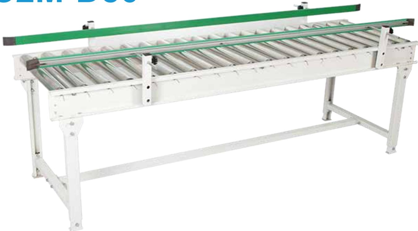
Convoyeur à rouleaux libres, ou gravitaires (L'effet de gravité s'obtient par une pente de 5% à 6% par réglage des pieds supports ), il est utilisé dans les domaines de l'emballage et du conditionnement afin d'assurer le transport et l'empilement de charges, cartons, bacs, caisses... à fonds plats et rigides.
