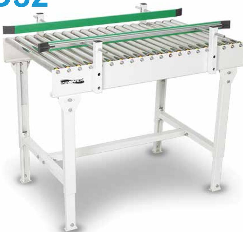
Convoyeur à rouleaux libres, ou gravitaires (L'effet de gravité s'obtient par une pente de 5% à 6% par réglage des pieds supports ), il est utilisé dans les domaines de l'emballage et du conditionnement afin d'assurer le transport et l'empilement de charges, cartons, bacs, caisses... à fonds plats et rigides.
