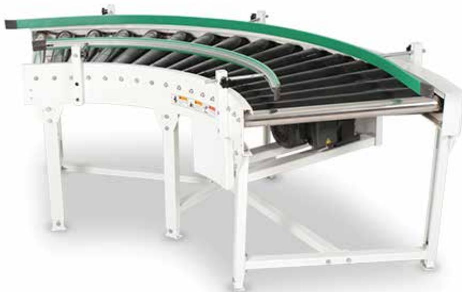
Le convoyeur courbé à entraînement avec une chaîne motorisée, assure une bonne orientation de la charge grâce à ses courbes équipées de rouleaux coniques; ces rouleaux coniques maintiennent l'alignement de la charge entre les guides latéraux. Les courbes de 90° sont munie de chaîne de haute résistance équipée d'un motor-réducteur.
