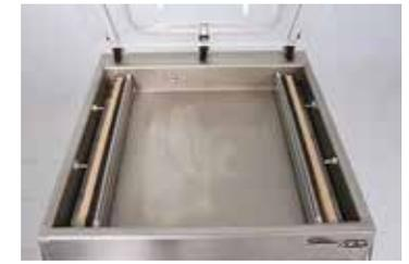
Deux barres de soudure qui permettent de souder plusieurs sacs dans les deux côtés à la fois
