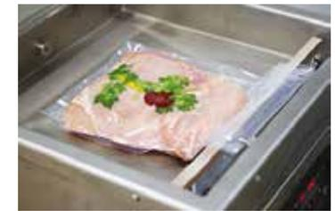
Une barre de soudure qui permet de souder des sacs à grandes dimensions.
