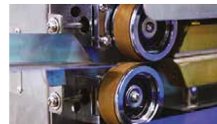
Rouleaux de soudure robustes et couverts par du téflon.
