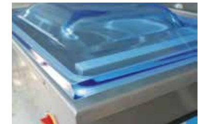
Barre de soudure robuste en acier inoxydable revêtu en teflon
