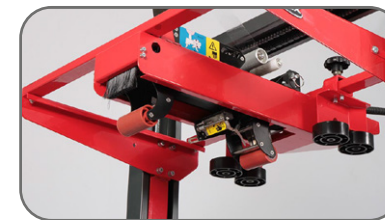
Mécanisme de scellage supérieur, avec un excellent attachement des cartons grâce aux 04 galets en haut de la machine
