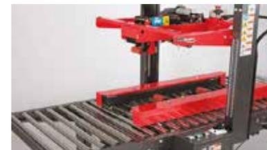
Convoyeur à rouleaux, et guides latéraux qui permettent un contrôle parfait des cartons de petites et moyennes dimensions.
