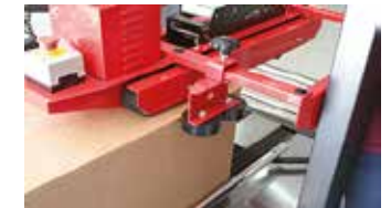
Contrôle parfait avec 4 bandes motorisées en haut et en bas munies de guides latéraux en bas et des galets latéraux en haut.
