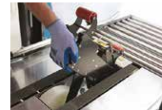
Têtes de ruban rapidement démontables sans clé.
