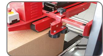
Contrôle parfait avec 4 bandes motorisées en haut et en bas munies de guides latéraux en bas et des galets latéraux en haut.
