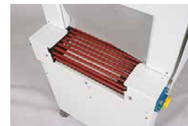
Tapis transporteur à rouleaux acier revetus en teflon.
