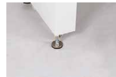
La machine est montée sur des pieds qui fixent la machine et les roues pour faciliter son déplacement.
