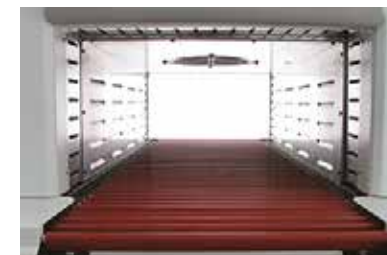
Le ventilateur fait tourner le flux d'air à 360°. L'intérieur du tunnel entièrement en inox
