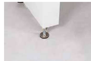
La machine est montée sur des pieds qui fixent la machine et des roues pour faciliter son déplacement.
