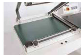
Système électro-magnétique qui assure la fixation de la barre durant la soudure.
