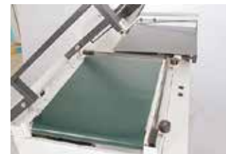
Convoyeur à bande motorisé pour déplacer le produit soudé jusqu'au tunnel de rétraction.
