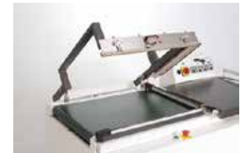
Convoyeur à bande motorisé qui conduit le produit soudé jusqu'au tunnel de rétraction.
