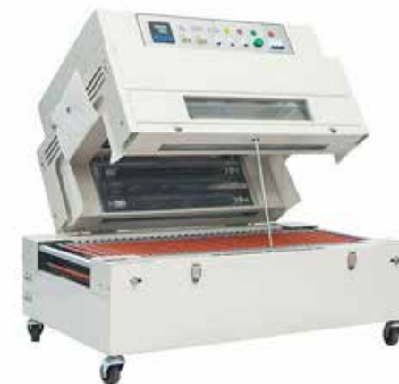
Tunnel ouverant qui permet une maintenece facile
