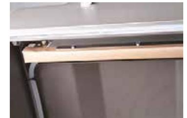
Barre de soudure robuste en acier inoxydable revêtu par un teflon
