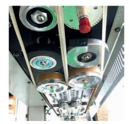
Rouleaux de soudure robustes et couverts par du téflon.
