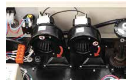
Double ventilateur de refroidissement
