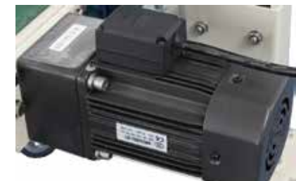
Moteur de convoyeur puissant 250W
