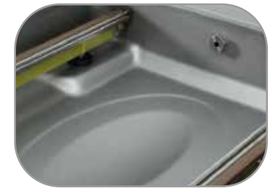
Deux barres de soudure qui permettent de souder plusieurs sacs dans les deux côtés à la fois
