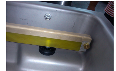
Barre de soudure robuste en acier inoxydable revêtu en téflon
