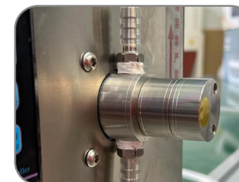
Pompe magnétique Avec une pompe magnétique en acier inoxydable, il peut remplir le liquide avec précision. Cette pompe a des caractéristiques de résistance à la chaleur et à la corrosion.
