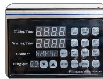
Panneau de commande Écran LCD tactile, permet d'ajuster le temps et la vitesse de remplissage pour plus de flexibilité et de suivre le nombre de bouteilles remplies.
