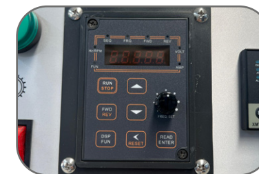
Vitesse variable du convoyeur par un variateur de fréquence.
