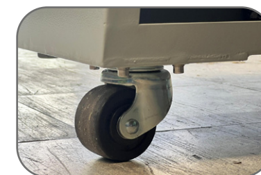
La machine est montée sur des pieds pour qui fixent la machine et des roues faciliter son déplacement.
