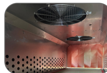
Les ventilateurs tournent le flux d'air à 360°. L'intérieur du tunnel entièrement en inox.
