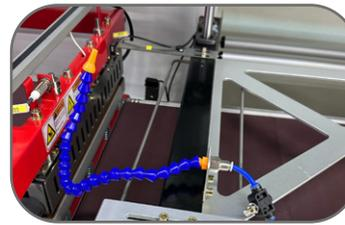
Tapis rapprochant entre les deux tapis pour un transfert lisse des produits; Un système intelligent qui détecte le début et la fin de l'emballage automatiquement.
