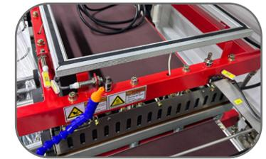
La barre de soudure fonctionne par un système pneumatique.
