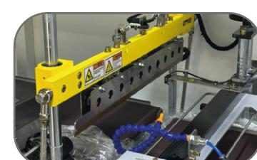
La barre de soudure verticale fonctionne par un système pneumatique.
