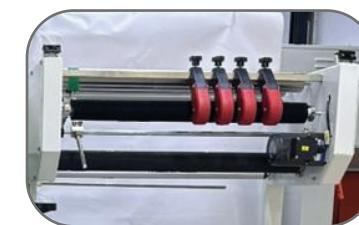
Système de perforation du film pour éviter la formation les bulles d'air.
