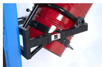
Pesage de fût précis grâce à un dispositif dans le bras du gerbeur
