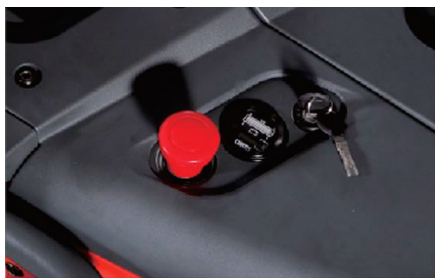
Bouton arrêt d'urgence, niveau de batterie et clés pour démarrage du gerbeur.
