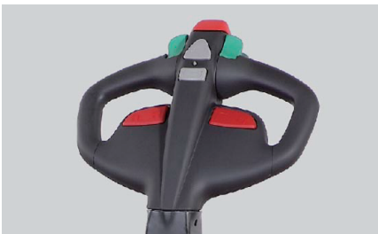
Poignée de commandes ergonomique avec bouton d'arrêt d'urgence central, il empêche que l'opérateur ne se retrouve coincé en faisant brièvement reculer le chariot lorsqu'il est activé.
