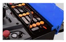
Batterie de 24V une capacité jusqu'a 210Ah, haute performance pour une opération longue durée.
