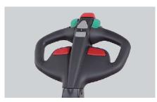
Poignée de commandes ergonomique avec bouton d'arrêt d'urgence central, il empêche que l'opérateur ne se retrouve coincé en faisant brièvement reculer le chariot lorsqu'il est activé.
