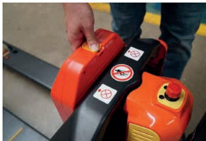
Guidage et verrouillage de la batterie sécurisés et facilités
