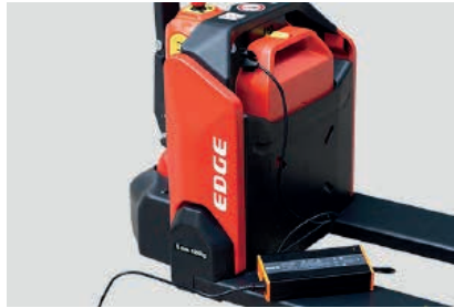
Prise de charge directement sur le coffre de la batterie
