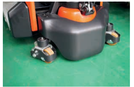
Roues stabilisatrices sur amortisseurs
