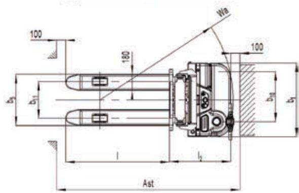
Une capacité de charge jusqu'à 1500kg avec une aptitude de surmonter des rampes d'un angle de 5/10% (Avec charge/Sans charge) ce qui facilite la manœuvrabilité du gerbeur dans les quais de chargement et le déplacement dans les entrepôt dans différentes conditions
