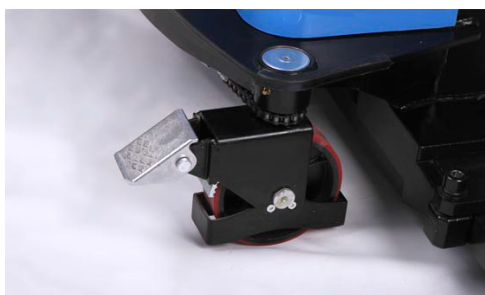
Roues directrices en Polyuréthane diamètre 18 cm avec frein de stationnement.
