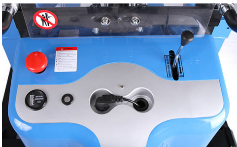
Bouton arrêt d'urgence, Afficheur de niveau de batterie et clé pour démarrage du gerbeur.
