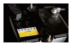
Deux batteries VRLA sans entretien d'une capacité de 85Ah assure une durée d'utilisation longue.
