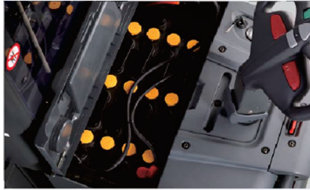
Batterie de 24V une capacité jusqu'à 350Ah, haute performance pour une opération longue durée.
