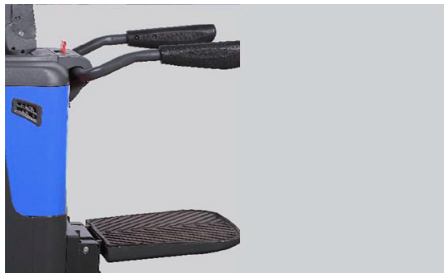
Plate-forme avec bras de protection, les plateformes rembourrées garantissent la sécurité dans toutes les conditions d'utilisation.
