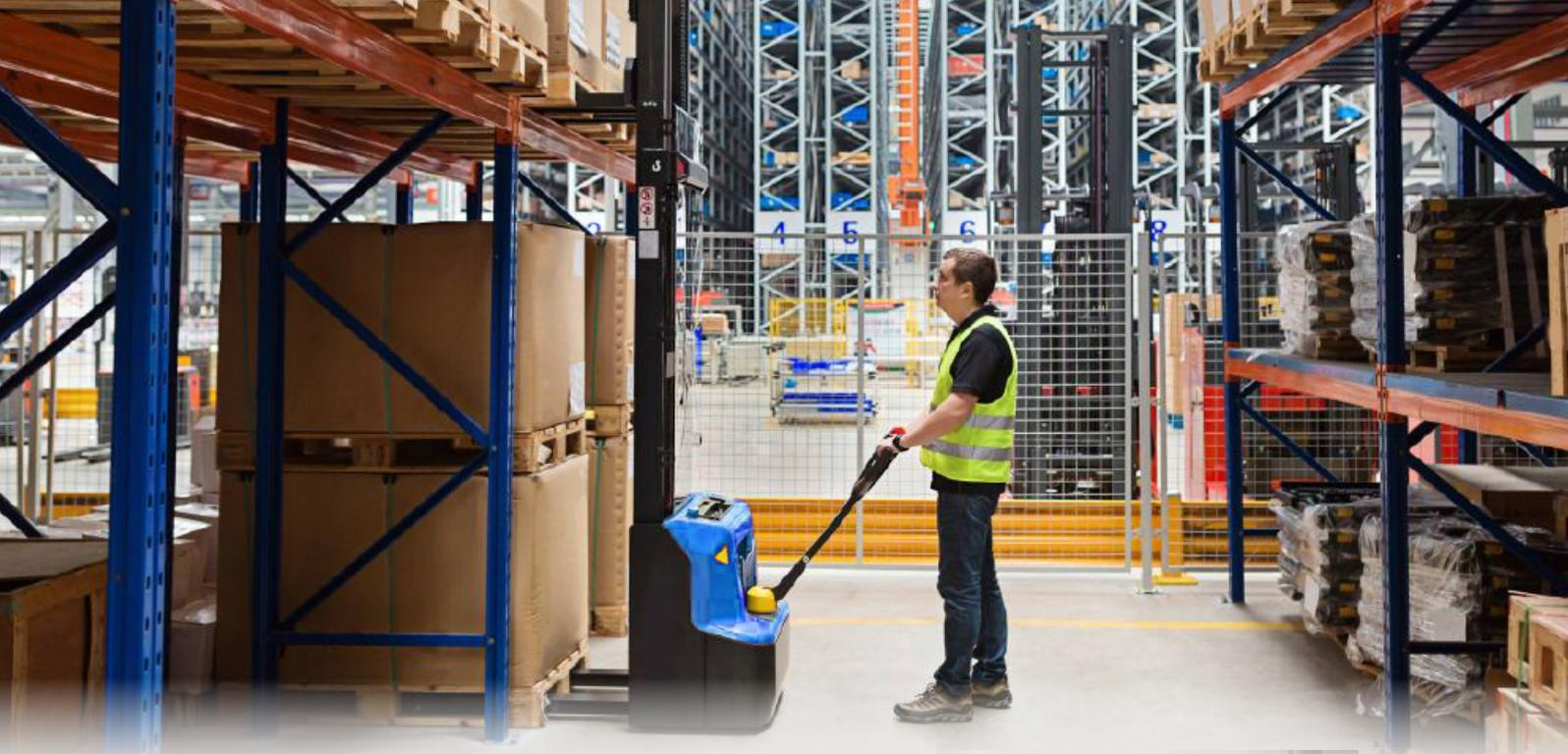
Une capacité de charge jusqu'à 1200kg avec une aptitude de surmonter des rampes d'un angle de 5/10% (Avec charge/Sans charge) ce qui facilite la manœuvrabilité du gerbeur dans les quais de chargement et le déplacement dans les entrepôt dans différentes conditions
