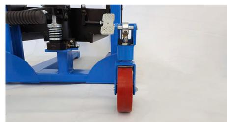
Roues directrices en Polyuréthane. système de freinage installé sur l'une des roues directrices donne une possibilité de blocage pendant la levée.
