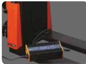
Prise sur boîtier de batterie pour un chargement facile de la batterie sans avoir besoin de prendre le batterie épuisée.
