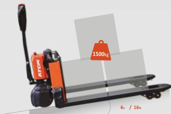
Capacité jusqu'à 1500kg et capacité à surmonter rampes jusqu'à 6/16 % (en charge/à vide) rend la transpalette adapté pour le travail dans les quais de chargement et à la livraison opérations dans des conditions différentes.
