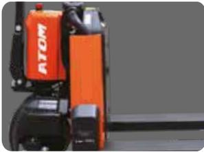
Le châssis du transpalette est entouré de couvercles en acier à l'air différent et assurant également la protection des composants.
