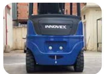
La nouvelle gamme de modèles de la série N se caractérise par l'assemblage de chargeurs équipés de moteurs à courant alternatif pour l'entraînement du mouvement et celui du système hydraulique. L'utilisation de haut-parleurs à moteur permet de réduire les coûts de maintenance en raison de l'absence de balais de charbon, mais également en raison de l'efficacité accrue de cette technologie par rapport aux moteurs à capteurs.
