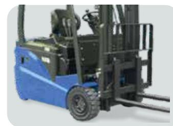
Système de conduite deux (2) roues motrice ajustable
