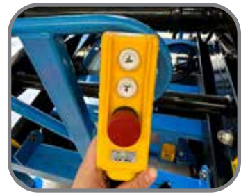
Télécommande vous pouvez contrôler la plate-forme de haut en bas par la télécommande n'importe où.
