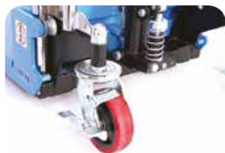
Frein de stationnement sur les roues directrices
