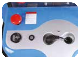
Bouton arrêt d'urgence. Afficheur de niveau de batterie et clé pour démarrage du gerbeur
