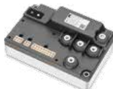
Contrôleur DC de marque américaine Curtis. Système de commande CAN-Bus qui donne un accès simple et rapide aux données et moins de câblage
