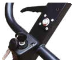
Clé de démarrage et bouton de levage électrique situés dans la poignée de levage
