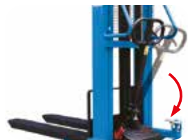
On peut toujours lève le gerbeur manuellement quel que soit la batterie est chargée ou faible
