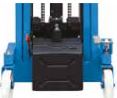
l'unité d'alimentation est situé en bas du gerbeur, ce qui améliore la stabilité du gerbeur et maintenir le centre de gravité aussi bas que possible
