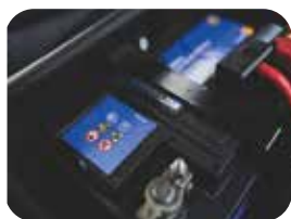
Quatre batteries de 12V (48V) en AGM sans entretien avec capacité de 60 Ah
