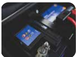
Batterie AGM 12V d'une capacité de 150Ah assurant une durée d'utilisation longue
