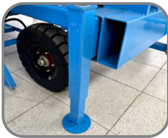
Stabilisateur 4 stabilisateurs de sécurité.
