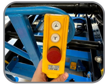
Commande manuel vous pouvez contrôler l'élévation et la descente par commande sur la plate-forme ou en bas sur le châssis
