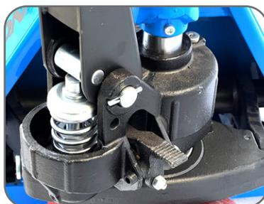
Pompe hydraulique galvanisée, une valve s'ouvre en cas de surcharge pour protéger la pompe.
