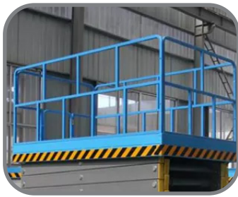
Plate forme démontable la porte de la plate forme assure la sécurité des travailleurs.
