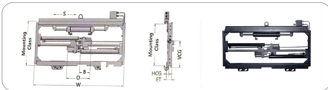
Le positionneur de fourches à déplacement latéral ajuste efficacement la distance entre les fourches pour manipuler des palettes de différentes tailles. Son déplacement latéral permet un ajustement précis de la position horizontale des marchandises, simplifiant les opérations d'empilage, de manutention, de chargement et de déchargement.
