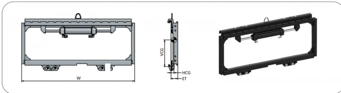
Les tabliers à déplacement latéral pour chariot élévateur, permettent de déplacer une charge d'un côté à l'autre pour un levage et un placement rapides et précis.
