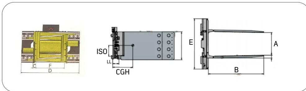
Pince à balle avec contact en catchouc pour protéger les marchandises lors de levage de manière sûre et efficace, telles que des cartons, des caisses en bois, des caisses en métal ou des sacs souples. Il est adapté aux opérations de manutention et de stockage sans palette dans les industries de la papeterie, des fibres chimiques, des ateliers, des ports et d'autres secteurs.
