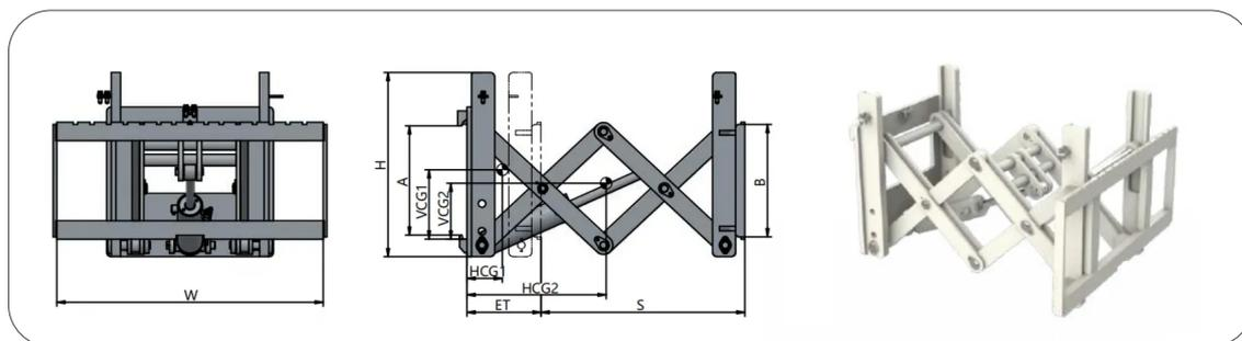
Extension des fourches permet de prolonger la longueur des fourches pour manipuler des charges plus longues ou volumineuses.
