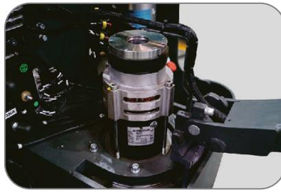
Le moteur de traction AC, conçu et produit par Schabmüller, est combiné au réducteur haut de gamme ZF et au frein électromagnétique. Le groupe moteur permet une vitesse de traction jusqu'à 8 km / h.
