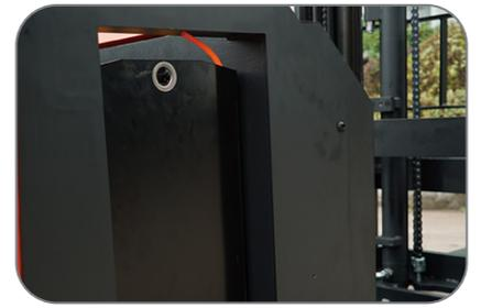
L'extraction latérale de la batterie permet d'assurer son remplacement simple, rapide et efficace
